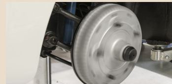
Rotující brzdový buben - simulace jízdy
